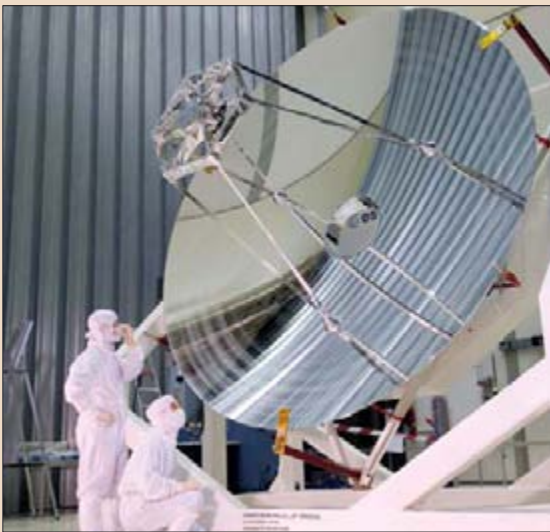
Зеркало европейского космического телескопа Herschel-Planck, предназначенного для исследований в инфракрасном и микроволновом диапазонах.
